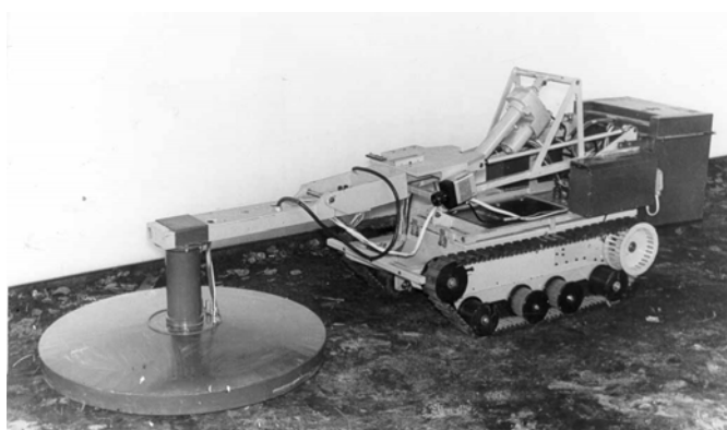
Макет широкозахватного поискового элемента, установленного на дистанционно управляемый робот носитель.
